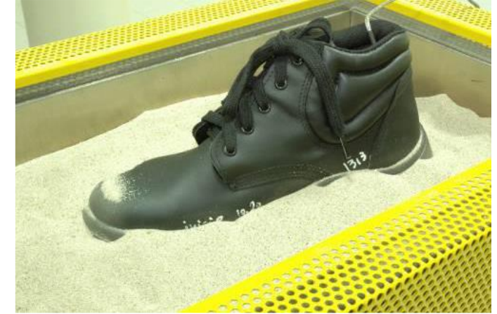
SCILED طريقة لتقييم عزل الأحذية ضد الحرارة. المصدر: 2019
